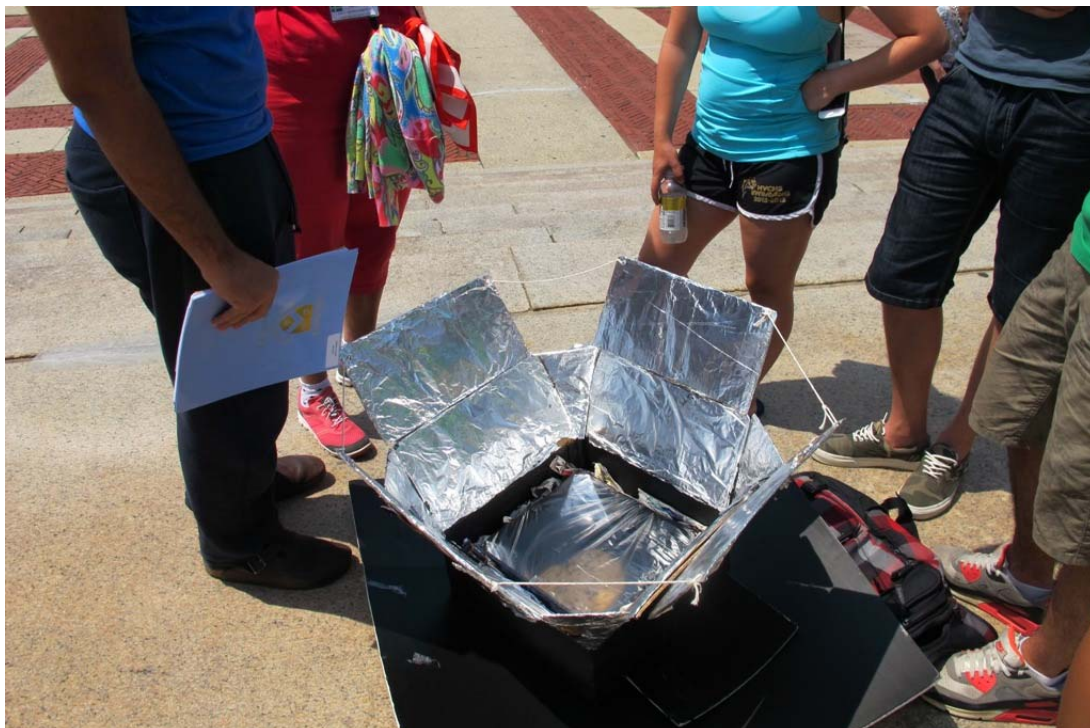
Några studenter experimenterar med att laga mat genom att fånga upp solens strålar och temperaturen visade upp till 250 gr berättade de för oss.
